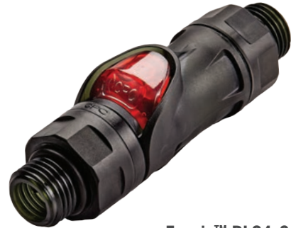
Everis™ PLQ4-Serie Nenndurchfluss von 6,4 mm (1/4") mit einem Kv von 1,1 (Cv 1,3) Anschlussoptionen: Schlauchtülle, arretierende Schlauchtülle, SAE- und G-Gewinde
